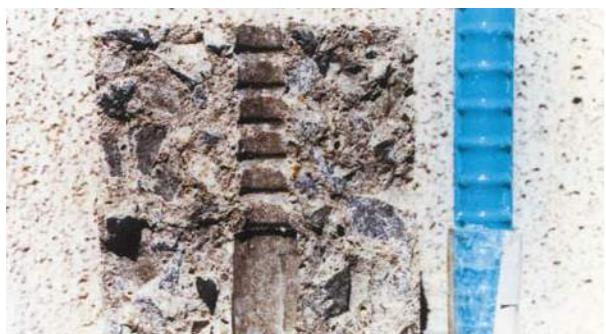
割裂後の供試体(塗膜損傷なし)
